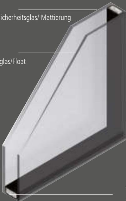
3-FACH-VERGLASUNG =  $U_g 0,6 \text{ W/m}^2\text{K}$
