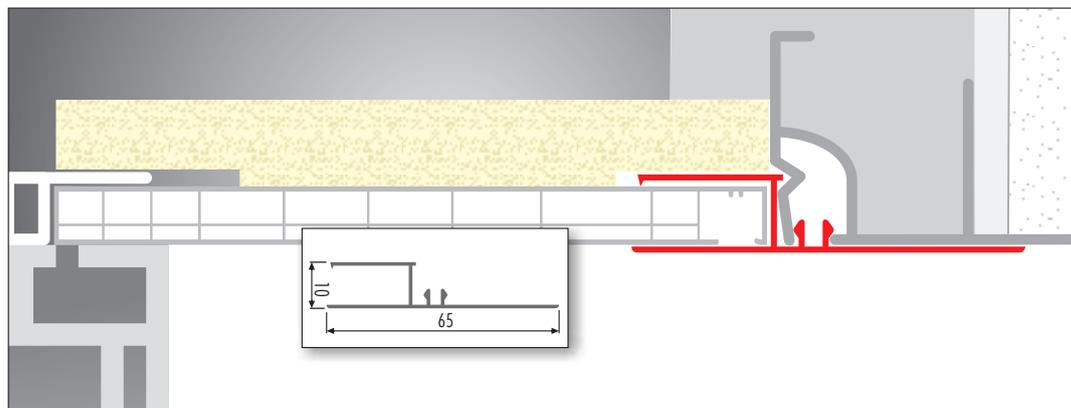
Mittels Schrauben wird hier der REVILEO® Deckel am Kasten befestigt. Die Nutung in der Isolation nimmt das Abrollprofil des Fensters auf. Den perfekten Abschluss übernimmt hier das Winkelklippprofil.
