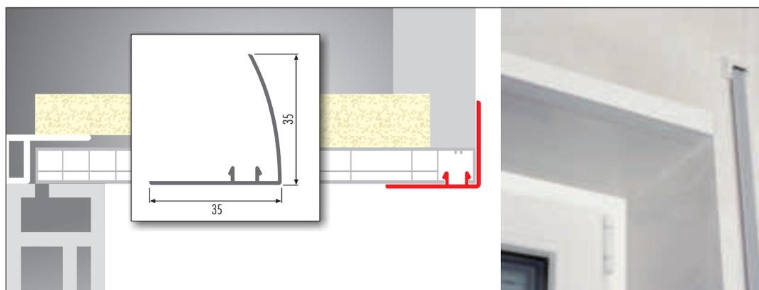
Das Seitenanschlussprofil mit Klippleiste, eingesetzt zwischen Mauer und Rolladenkastendeckel bildet den seitlichen Abschluss zur Laibung und ermöglicht den Ausgleich von Maßtoleranzen. Die Klippleiste deckt die Fuge zwischen Rolladenkastendeckel und Laibungsprofil ab.
