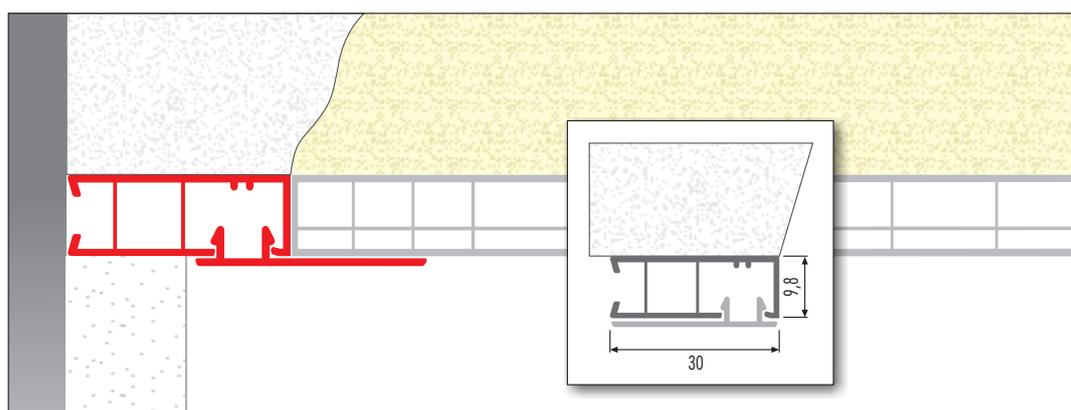
Beim Einsatz des Seitenanschlusses verdeckt die Klebleiste die entstehende Fuge und beim Rolladenkastendeckel die raumseitige Öffnung des Anschraubstückes.
