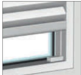
Montagemöglichkeit in die Glasleiste mit Spannschuhen.
