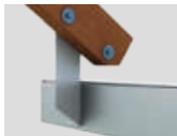
Dachsparrenmontage (bei überstehendem Dach)
