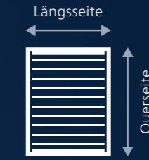
Längsseite = Lamellen hintereinander Querseite = Lamellen nebeneinander
