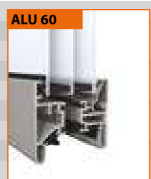
ALU 60 Panorama-Tor 60 mm Plexiglas-Dreifachscheiben Optical 40 mm (4-14,75-2,5-14,75-4 mm)
